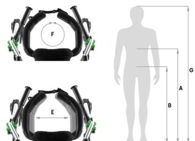
Assegurarse que los círculos A y B representados en la figura, entren en el rango de medida indicado para el soporte torácico y pélvico.
