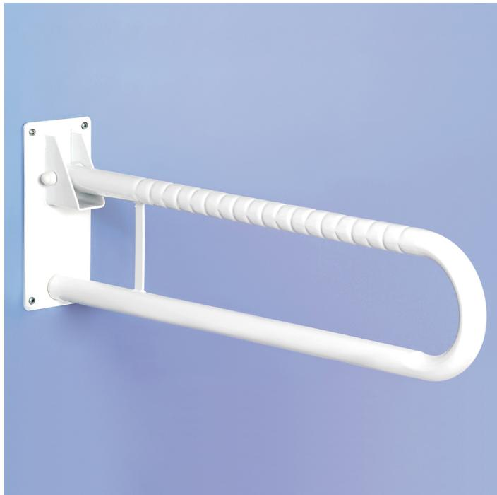
Acero pintado. Va montada sobre la pared. Es abatible y cuando está fuera de uso, queda fijada en posición vertical. No está recomendada para ambientes húmedos. Tubo de 32 mm de diámetro. Placa a la pared: 10 x 23 cm (fijada con 4 tornillos)
