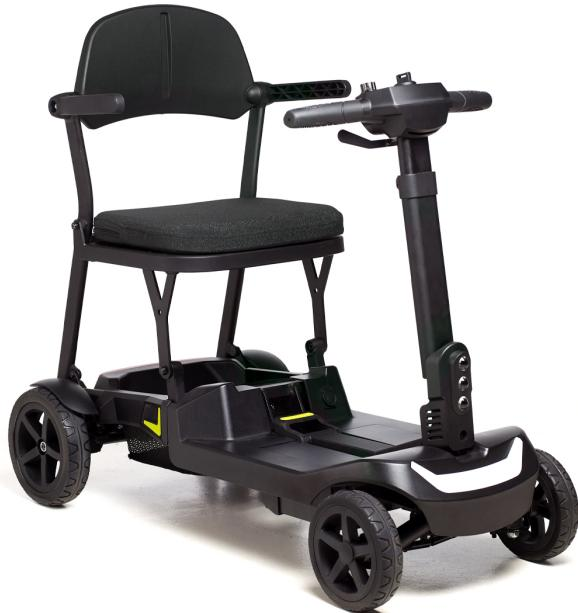
Foldi es el scooter pensado para viajar. Se pliega en un solo paso, ocupa muy poco espacio y es ultraligero (17 Kg). Incorpora luces LED delanteras y traseras y una batería de litio de 10 Ah con autonomía de hasta 15 km. Gracias a su tamaño compacto, ofrece excelente maniobrabilidad en espacios reducidos (ascensores, pasillos y maleteros).
