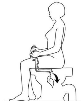
**Paso 4.** Abra las lengüetas apretando el mango y sacuda el papel para que caiga al WC. Limpie con detergente sin disolvente con un pH de 6 a 9, o con una solución desinfectante al 70%. Si es preciso se puede descontaminar a 85°C.
