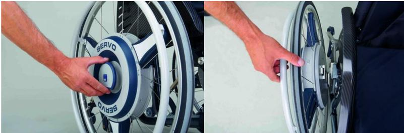
Todas las sillas de ruedas plegables con SERVO se pueden plegar de forma compacta y sencilla. El nuevo sistema de alojamiento de las ruedas NUI de SERVO permite apilar las ruedas de accionamiento unas sobre las otras o colocarlas.
