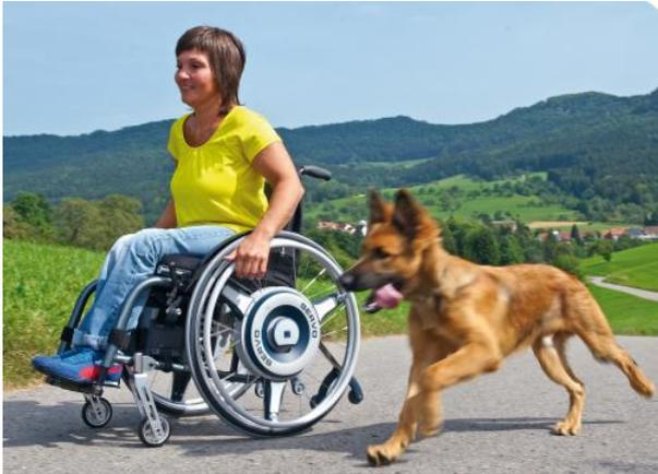
Los motores de alto rendimiento, integrados discretamente en el par de ruedas, facilitan el movimiento de impulsión inicial del usuario de la silla de ruedas.
