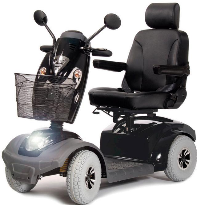
El scooter MYSTERE proporciona una gran libertad de movimientos por su excelente maniobrabilidad gracias a las cuatro ruedas neumáticas con amortiguación, garantizando un viaje confortable. El potente motor eléctrico permite superar pendientes de hasta 12º. Las dos baterías de 50 Ah proporcionan gran autonomía a este robusto scooter que soporta hasta 180 kg. Es ideal para trayectos largos
