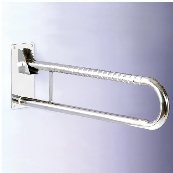
De acero inoxidable, va montada sobre la pared. Es abatible y cuando está fuera de uso, queda fijada en posición vertical. Tubo de 32 mm de diámetro. Placa de pared de 10 x 23 cm, fijada con 4 tornillos.
