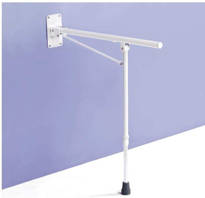
Fabricada en acero inoxidable y aluminio. El pie ajustable ofrece un soporte adicional, especialmente útil cuando las paredes disponibles no garantizan la seguridad suficiente. Abatible, cuando no se utiliza queda fijada a la pared. Tubo de 30 mm de diámetro. Placa a la pared de 10 x 17 cm, fijada con 4 tornillos.
