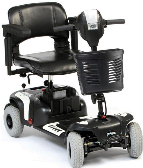
El PRISM SPORT es un scooter de reducidas dimensiones, con unas ruedas de gran tamaño de 230x100 mm. (9"X4") que ofrecen un mayor confort a la hora de su conducción. Dispone de baterías de 20Ah que proporcionan mayor autonomía. Incorpora luces delanteras para una mayor seguridad.
