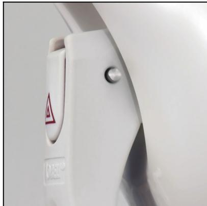
**Indicador de seguridad** El botón de seguridad comprueba constantemente el vacío de las ventosas. Si el botón está totalmente introducido en la ventosa indica que la fuerza adhesiva es óptima y la asidera está lista para utilizarse. Si el botón esta fuera, mostrando su color rojo de advertencia, debemos instalar la asidera de nuevo.
