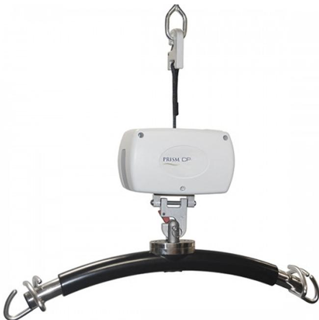
La más pequeña de las grúas de techo, compacta y ligera, pesa solo 4,5 kg y levanta hasta 200 kg. Elevación eléctrica hasta 2,10 metros. Práctica y fácil de usar para cualquier tipo de transferencia, incluso elevaciones desde el suelo. Motor silencioso y con movimiento de arranque y parada suaves. Mando digital eléctrico. Indicación LED que indica el nivel de batería.
