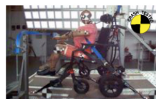
891 Anclaje (4 anillos) para el transporte, en dirección del sentido de marcha, en vehículos homologados en movimiento (coche, bus, etc.) Consulte el manual de uso y mantenimiento suministrado con la ayuda.
