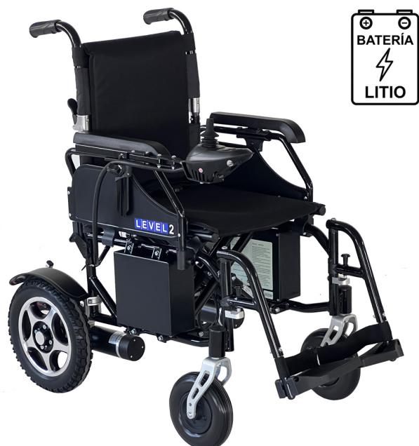
Silla de ruedas eléctrica plegable con batería de Litio de 20 Ah. Muy ligera, fabricada en aluminio, que con dos potentes motores de 200 W cada uno, ofrece una generosa autonomía para este tipo de sillas electrónicas de hasta 20 km.
