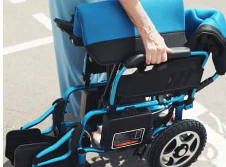
Incorpora ruedas traseras de 12" de poliuretano macizo sobre llanta de aluminio, las ruedas delanteras de 8" montadas sobre horquilla de aluminio.
