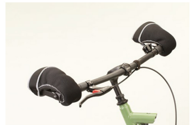
875 Fijación de muñeca con soporte y guante multiajustable de forma independiente.
