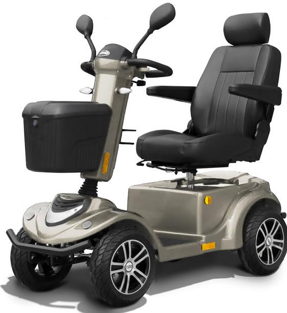
PEGASUS es un scooter de altas prestaciones y un completo equipamiento de serie. Su gran potencia (motor de 800W) y excelente maniobrabilidad gracias a las cuatro ruedas neumáticas con amortiguadores, garantizan la mayor comodidad y libertad en desplazamientos largos, con una autonomía de hasta 45km.
