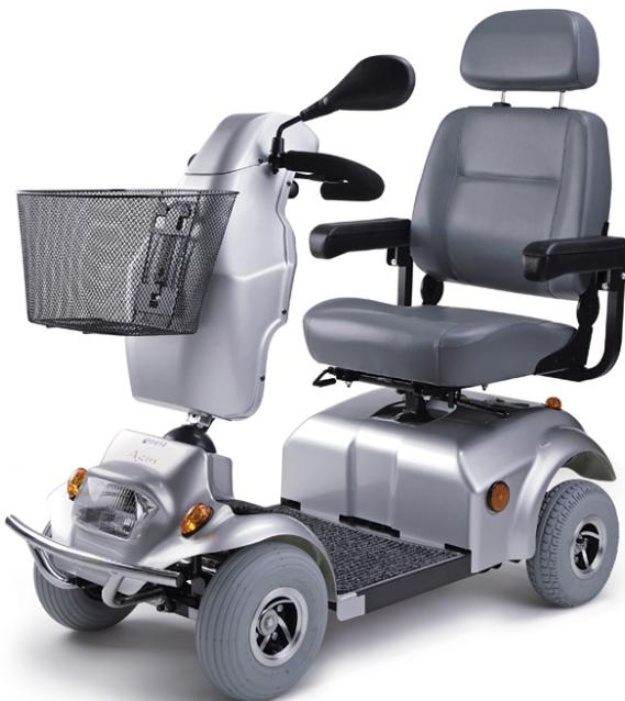
El scooter AGIN proporciona una gran libertad de movimientos por su excelente maniobrabilidad gracias las cuatro ruedas neumáticas y con amortiguación para garantizar un viaje confortable. El potente motor eléctrico permite superar pendientes de hasta 10º y las 2 baterías proporcionan gran autonomía en este robusto scooter y lo hacen ideal para los trayectos largos.
