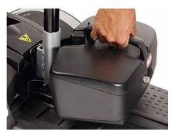
Potentes baterías de 21 Ah Las baterías de 21Ah son extraíbles, lo que permite cargarlas tanto en el scooter como fuera de él y proporcionan una autonomía aproximada de 22 km.
