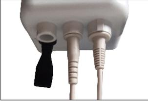
Antes de utilizarlo, compruebe que el mando a distancia y el cilindro están correctamente conectados a la unidad de control (página 22). Compruebe el estado de la caja de control y de la batería.
