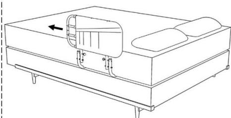
2- Coloque el arco de la base (A) en los tubos laterales (B). Presione los pivotes para insertar a los tubos.
