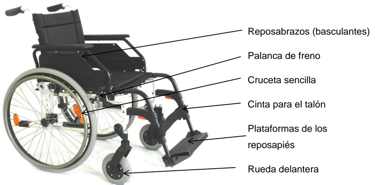
(Fig. 35: Caneo E y B 120kg de peso del usuario)
