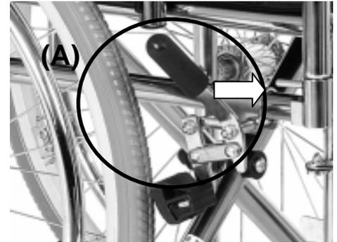
Para ajustar los frenos, afloje los dos tornillos (B) y deslice el conjunto del freno para obtener el siguiente valor entre la rueda y la pastilla del freno en posición no bloqueada:
