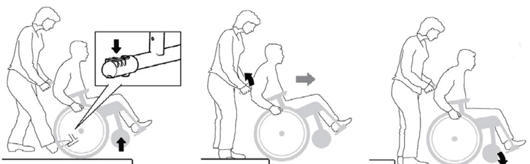
Para bajar de espaldas, el acompañante deberá acercarse al obstáculo y empujar la silla hacia atrás, baje la rueda trasera y después la delantera levantándola un poco. Una vez haya bajado completamente el escalón el acompañante puede bajar las ruedas delanteras.
